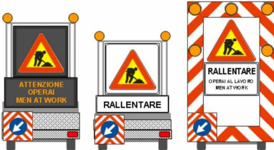
Figura 1: esempi di preavviso (carrelli con PMV o di tipo semplice o segnali mobili) da utilizzare in presenza di operai al lavoro sulla carreggiata nelle fasi di installazione della segnaletica. Il pannello 90x90 Fig. II 398 Art.38 Reg., va obbligatoriamente applicato contestualmente al posizionamento del carrello.
