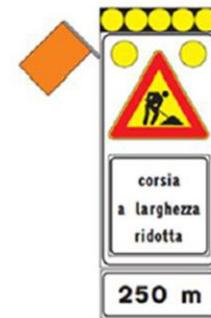
Figura 15: "presegnale di cantiere mobile" derivato dalla fig. Il 399/a Art.39 Reg., da impiegare per lavori sulla sola corsia di emergenza ridotta.
