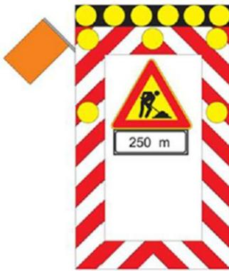
Figura 14: "segnale mobile di preavviso" derivato dalla fig. Il 400 Art.39 Reg. da impiegare per lavori sulla sola corsia di emergenza.
