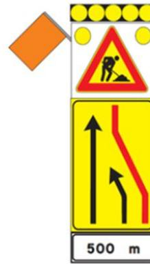
Figura 13: "presegnale di cantiere mobile" fig. Il 399/a Art.39 Reg., da impiegare su tratti autostradali con corsia di emergenza ridotta per la chiusura di una o più corsie di transito (la figura esemplifica la chiusura della corsia di marcia in dx).
