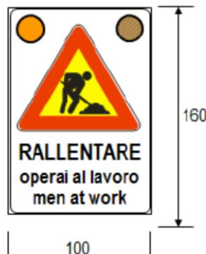
Figura 18: pannello composito di presegnalazione per lavori eseguiti lungo le corsie di decelerazione o sulle rampe di svincolo, dotato di 2 lampade a led ad alta efficienza diam. 200 mm. Superficie della targa non inferiore a 1,5 mq con lato del triangolo lavori in corso non inferiore a 90 cm. Posizionamento sul margine destro in coincidenza dell'ago di inizio della decelerazione e ripetuto in condizioni di non perfetta visibilità.
